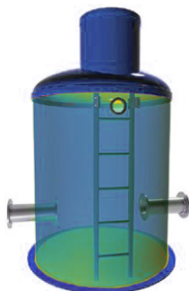
Рис 18. Общий вид смотрового колодца.
