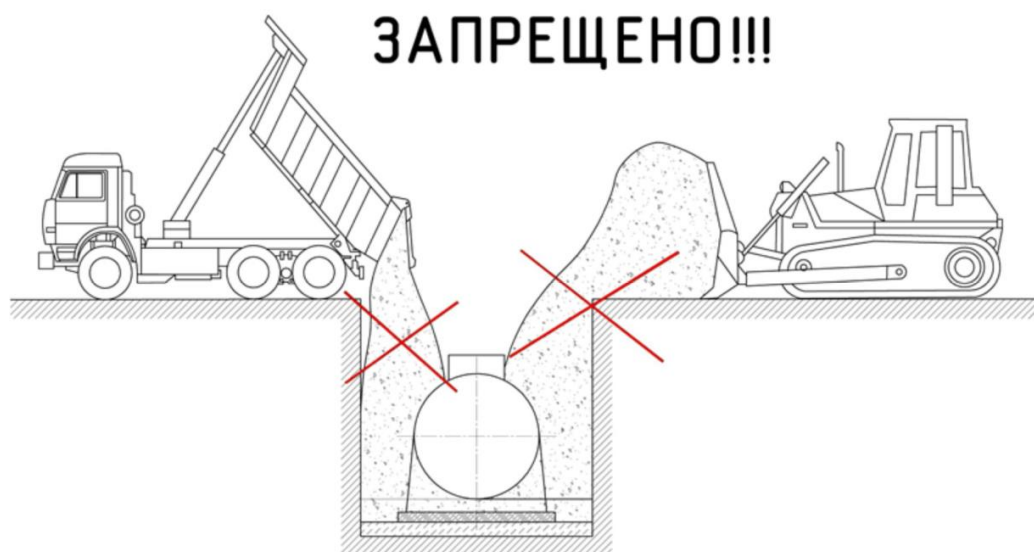
Пример НЕПРАВИЛЬНОЙ засыпки емкости
